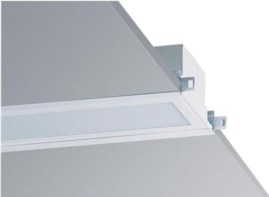
Direkt strahlende LED-Einbauleuchte mit Opalscheibe. Leuchtenkörper Stahlblech aus einem Stück gefertigt, weiß pulverbeschichtet, mit umlaufendem hochgestelltem Gehäuserand, mit Befestigungssatz für den Einbau in sichtbare (S3) und verdeckte (S1 und Gipskarton) Trageschienen-Konstruktion. Stahlblechrahmen mit eingelegter Opalscheibe mit verdeckten Federn gehalten und abklappbar. IP 40 in Richtung Nutzraum, IP 20 in Richtung Deckenzwischenraum.
