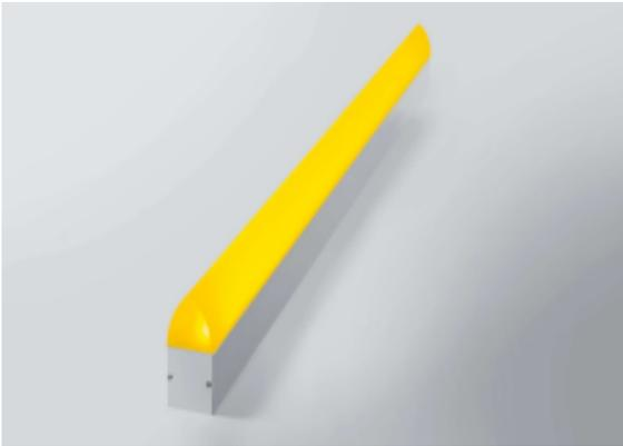
Leuchte für Gelblichtbetrieb (Gelblichtfilter <math><500\text{nm}</math>) mit Snap-In-System aus pulverbeschichteten stranggepressten Alu-Profilen. Pulverbeschichtung in RAL 9010 ausgasungsfrei Abdeckung mit tropfenförmiger opalisierter Wanne aus Acrylglas PMMA. Elektroanschluss über innenliegenden Klemmenblock. Leuchte auf chemische Beständigkeit, Strömungsverlauf und Partikel geprüft für ISO Klasse 1. Leuchte ist frei von Lackbenetzungsstörenden Substanzen (LABS-Frei).
