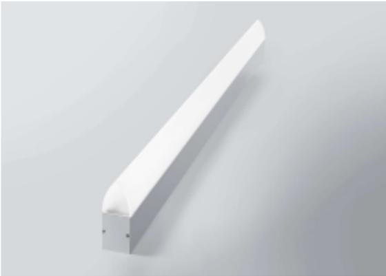
Leuchte für Weisslichtbetrieb mit Snap-In-System aus pulverbeschichteten stranggepressten Alu-Profilen. Pulverbeschichtung in RAL 9010 ausgasungsfrei Abdeckung mit tropfenförmiger opalisierter Wanne aus Acrylglas PMMA. Elektroanschluss über innenliegenden Klemmenblock. Leuchte auf chemische Beständigkeit, Strömungsverlauf und Partikel geprüft für ISO Klasse 1. Leuchte ist frei von Lackbenetzungsstörenden Substanzen (LABS-Frei).
