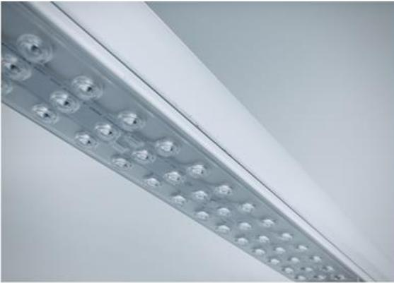
LED-Lichtbandeinsatz für VICO-Trageschienen mit dreireihigem frei wählbarem Linsensystem und mit verschiedenen Lumenpaketen. Die Einsätze sind in verschiedenen Längen erhältlich und sind in den Steuermodi ND und DA bestellbar. Die Montage/Demontage erfolgt werkzeuglos an den Tragschienen. Optional sind Notlichteinsätze mit Akku für 3 Std. oder Einsatz für Zentralbatterie lieferbar. Ebenfalls ist Sensorik erhältlich.
